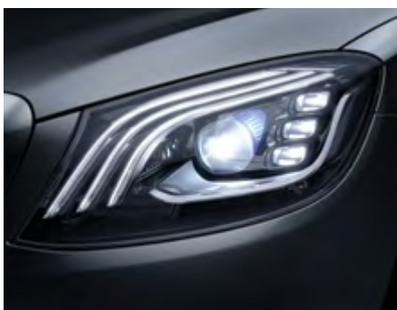
Cụm đèn trước MULTI-BEAM LED với 3 dải đèn LED chiếu sáng ban ngày
