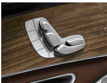
Ghế người lái & hành khách phía trước chỉnh điện với bộ nhớ 3 vị trí
