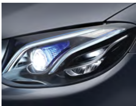
Cụm đèn trước MULTI-BEAM LED
