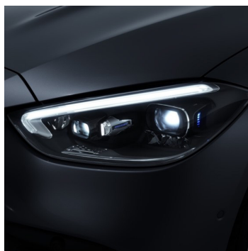
Cụm đèn trước DIGITAL LIGHT với công nghệ hỗ trợ mở rộng góc chiếu ULTRA RANGE Highbeam, tích hợp đèn LED chiếu sáng ban ngày
